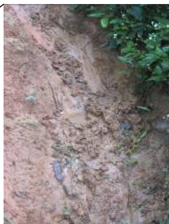
Figura 20 (esquerda): No ponto 3 de avaliação de amostras, a alta declividade gera maior transporte de material por escoamento superficial e perda de solo. Figura 21 (direita): A textura aparente de solo argiloso favorece a sua selagem e o aumento do poder erosivo (corrida de lama). Fotos: Beatriz Triane, 2008.
