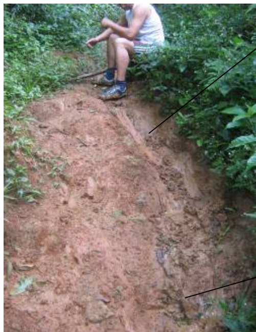
Figura 20 (esquerda): No ponto 3 de avaliação de amostras, a alta declividade gera maior transporte de material por escoamento superficial e perda de solo. Figura 21 (direita): A textura aparente de solo argiloso favorece a sua selagem e o aumento do poder erosivo (corrida de lama). Fotos: Beatriz Triane, 2008.
